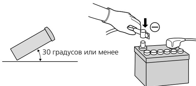
**Предупреждение:** Не отключайте клеммы аккумуляторной батареи автомобиля, оснащенного навигационным компьютером, так как это приведет к стиранию всех установок, сохраненных пользователем в памяти компьютера. Вместо этого следует предпринять дополнительные меры безопасности для предотвращения коротких замыканий в процессе установки устройства.
